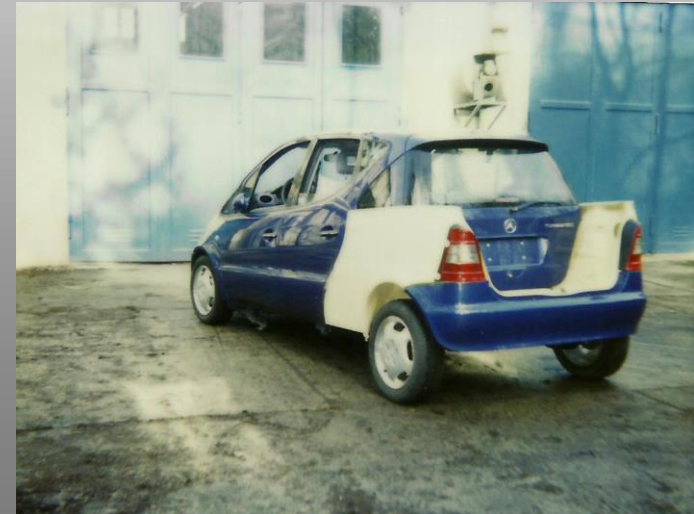
„Landauer“, Umbau der A-Klasse auf verlängerten Radstand
