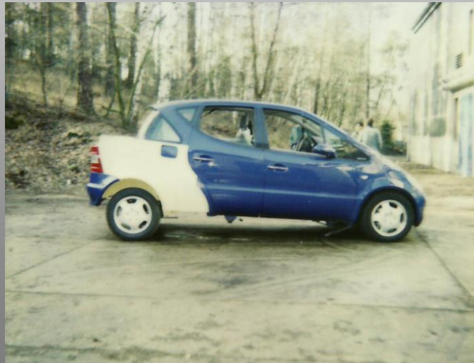
„Landauer“, Umbau der A-Klasse auf verlängerten Radstand
