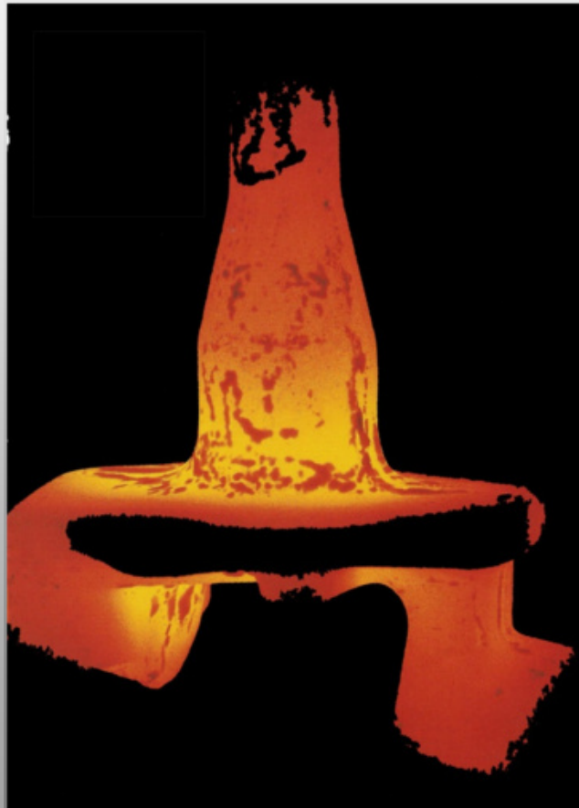
Nach dem Schmiedeprozess, im Gesenk geschmiedeter Achsschenkel
