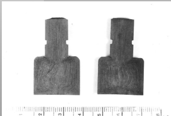
Faltenbildung in der Anfangsphase infolge zu geringem Übergangsradius vom Zapfen zum Kopf
