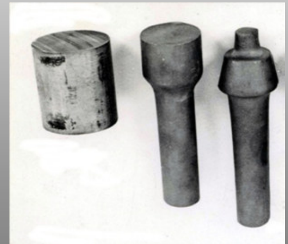
Bilder 5 und 8. Beispiele für das Reckwalzen und für das Vorwärtsfließpressen von Turbinenschaufeln
