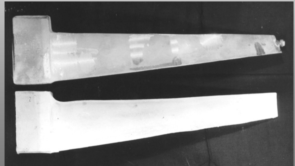
Bild 18. Turbinenschaufeln auf dem Gegenschlaghammer geschmiedet bis 800 mm Länge
