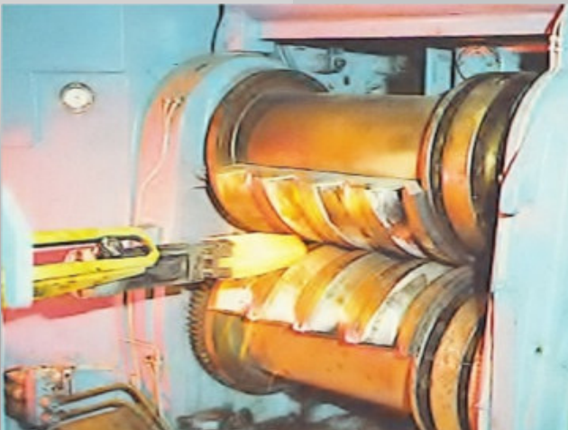
Bilder 5 und 8. Beispiele für das Reckwalzen und für das Vorwärtsfließpressen von Turbinenschaufeln
