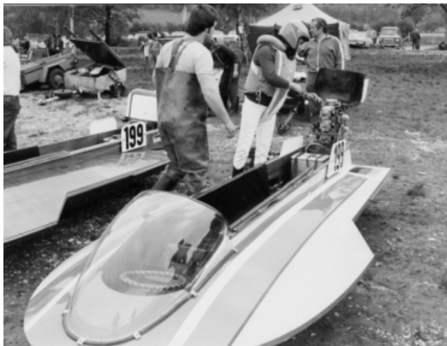
Propriдер- Boot mit 3-Zylinder- Eigenbaumotor 1978 U. Feger, 1975
