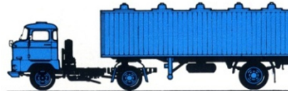
W 50 L/S Sattelzugmaschine mit Sattelaufleger zum Transport von Bier HLS 90.45/4
