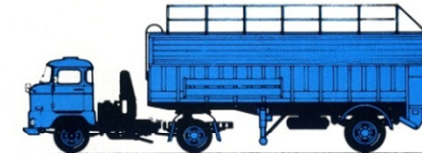
W 50 L/SM-1 Sattelzugmaschine mit Sattelaufleger zum Transport von Mischfutter HLS 90.48/1
