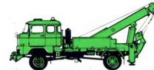
W 50 LA/AB Abschlepp- und Bergefahrzeug *) *) mit Allradantrieb
