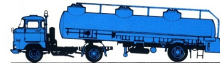
W 50 L/S-FB Sattelzugmaschine *) mit Sattelaufleger zum Transport von Kraftstoff HLS 100.45/2
