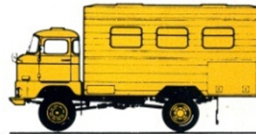
W 50 LA/W – ND Werkstattkofferverfahrzeug *) mit Allradantrieb und Niederdruckbereifung
