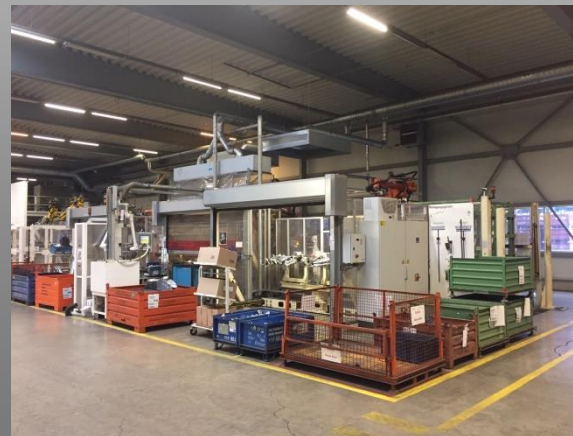
Innenansicht Halle 10 mit Fertigungsanlagen der Widerstandsschweißtechnik
