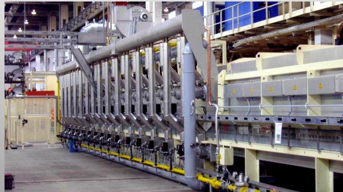
Gas- und elektrobeheizter Ofen
