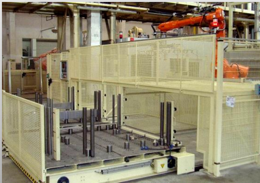
Unterbrechungsfrei beladen der Platinen
