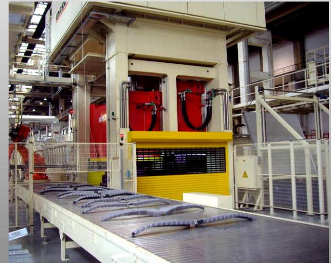
Entnahmeband nach Umformen
