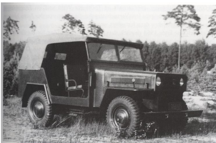
Das erste im Juni 1952 fertiggestellte Versuchsmuster des P 2 mit dem Motor OM 6-35; Konstruktion, Musterbau und Versuch erfolgten im FEW (Archiv Günter Caspari)
