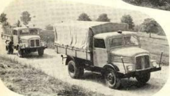
Der Standard-LKW unserer Fertigung ist die jetzt zum Typ 8 1000-l weiterentwickelte Vorversion mit Vierzylinder-Dieselmotor, der in unserer Wirtschaft und in vielen Ländern der Erde im Einsatz ist. Gleichfalls mit einer Vielzahl von Aufbauten ausgerüstet, läßt er sich allen Einsatzbedingungen anpassen. Entsprechend der wirtschaftlichen Abstimmung mit den anderen sozialistischen Ländern wird er zu den schwersten LKW zählen, die unser Industriewerk in Zukunft produziert
