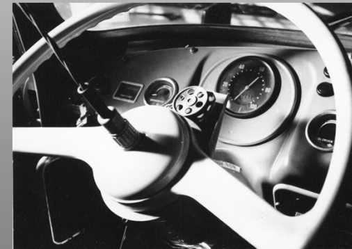
Messlenkrad 2.Ausführung: Kraft- über Dehnungsmessung (DMS) Quelle: Messbericht Nr. 83/69 (Herr Pieper)
