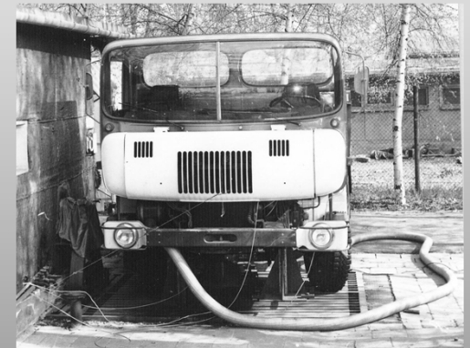
Innengeräuschanalyse am Fahrzeug L60 mit Fahrerhaus 6400 auf dem Freiprüfstand des VEB WTZ Automobilbau Karl-Marx-Stadt Quelle: Versuchsbericht PM 2/77 des VEB WTZ
