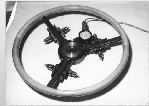
Messlenkrad 1.Ausführung: Kraft- über Federwegmessung Quelle: Messbericht Nr. 16/65 (Herr Lehmann)
