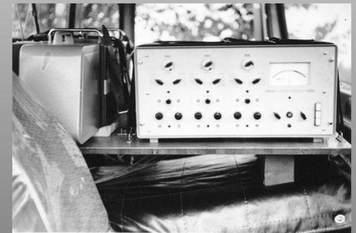
Typischer Messaufbau auf der Motorhaube des LKW W50, links Einlaufkassette des Lichtstrahloszillographen, rechts 3-Kanal-Trägerfrequenz-Messverstärker Quelle: Messbericht Nr. 97/71 (Herr Hecht)
