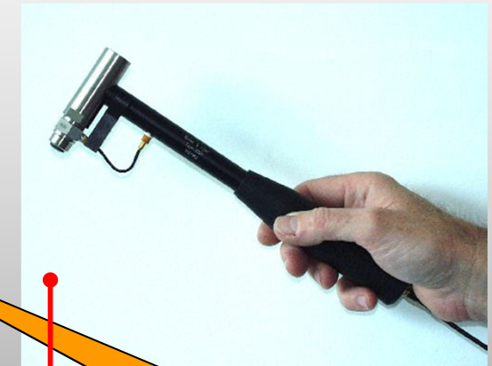
Anschlagen des Gehäuses mit dem Impulshammer
