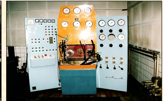
Eigenkonstruktion und selbst produzierte Geräteprüfstände. Abb. - für Kraftstoffpumpen
