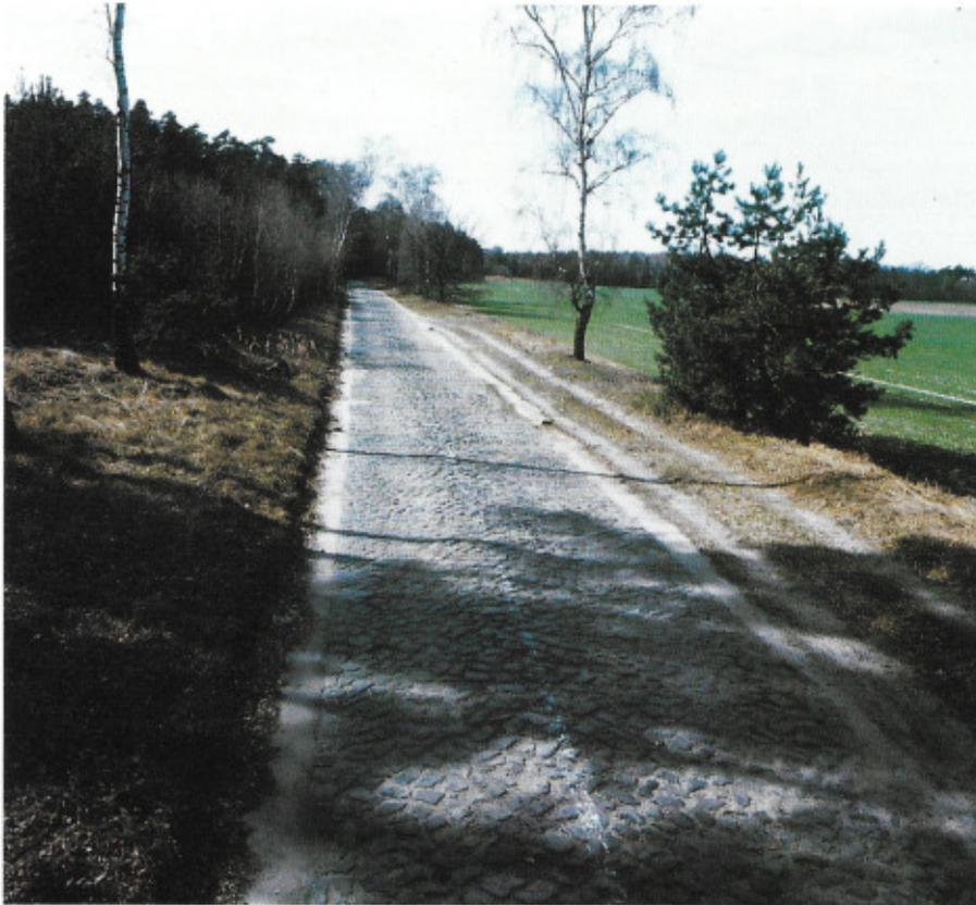
EGL-eigene Schlechtwegstrecke, 3,8 km lang, mit welligem Kopfsteinpflaster, für Untersuchungen: Lebensdauernachweis Gesamtfahrzeug mit baugruppenabhängigen Raffungsfaktoren von 5 bis 40, Fahrkomfort, Ladungssicherung.
