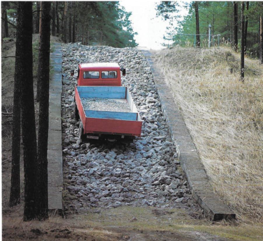
Geröllhänge mit fester und loser Oberflächenstruktur, Steigung 40 %, für Untersuchungen:
