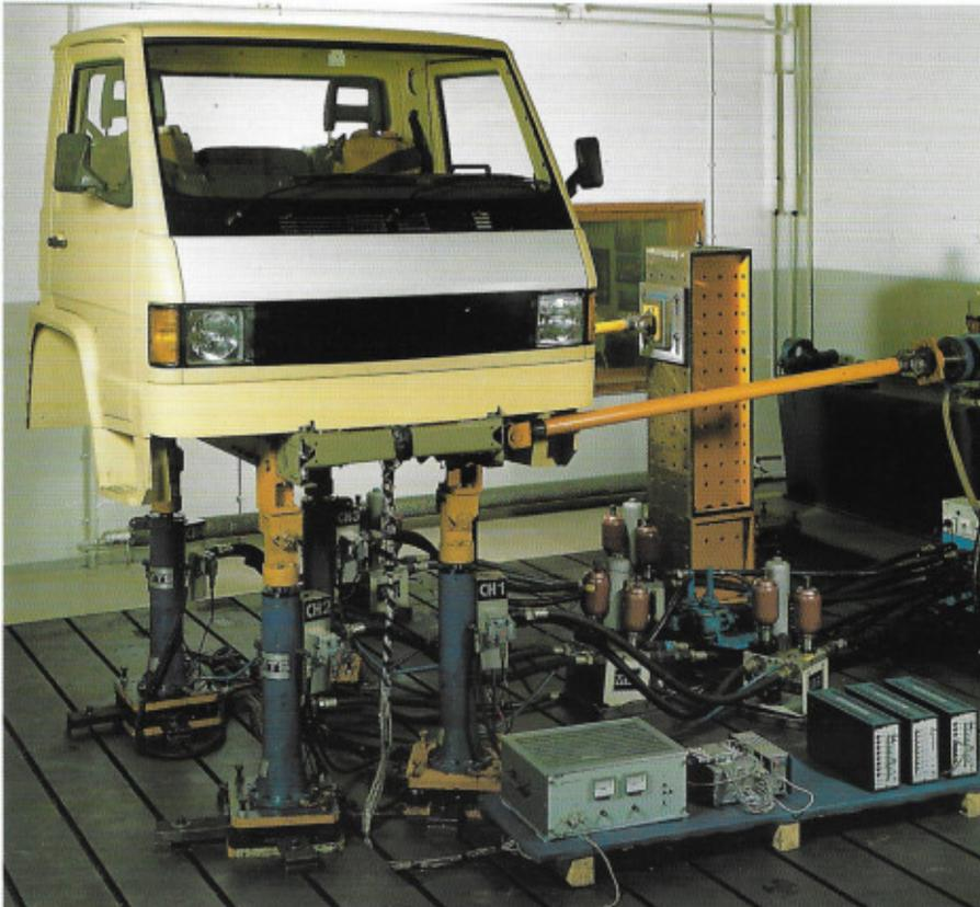
Unser Betriebsfestigkeits- und Schwingungslabor ist in der Lage, Prüfungen an Kraftfahrzeugeinzelteilen bis zum Gesamtfahrzeug mit modernsten Prüfeinrichtungen der Firmen MTS und Schenck durchzuführen.
