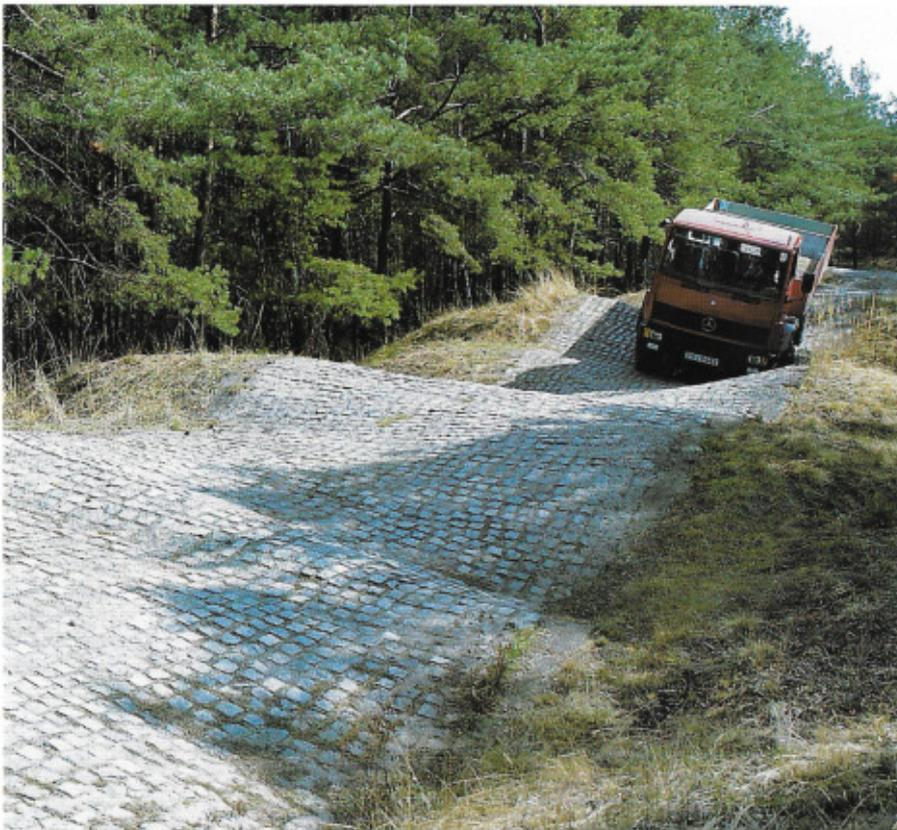
Verwindungsbahn, 200 m lang, größte Amplitude 1000 m, geeignet für:
