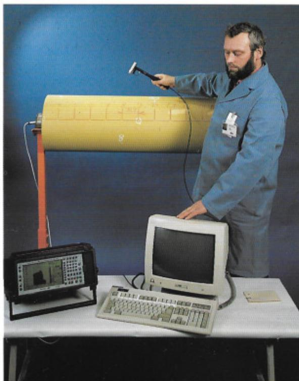
Bestimmung der Körperschall-Übertragungsfunktion
