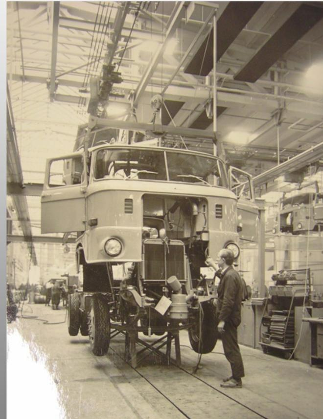
Aufsetzen des Fahrerhauses
