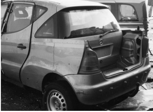
Erste Schritte zum „Vaneo“, -Radstandverlängerung einer Mercedes- Benz „A-Klasse“ für Voruntersuchungen
