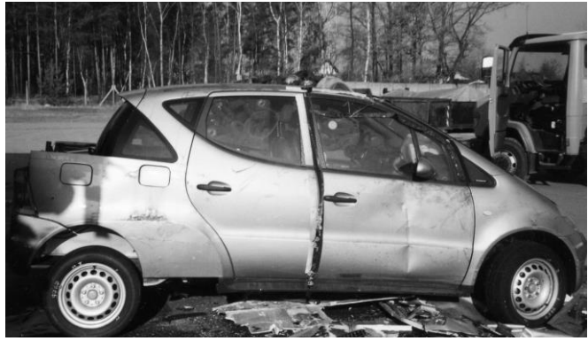
Erste Schritte zum „Vaneo“, -Radstandverlängerung einer Mercedes- Benz „A-Klasse“ für Voruntersuchungen
