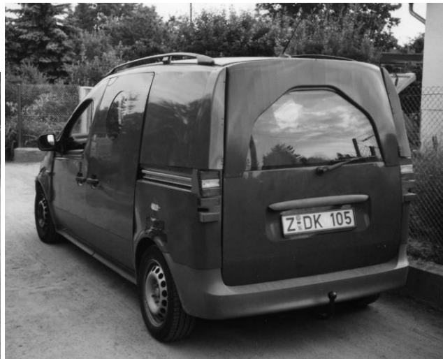
Erste Schritte zum „Vaneo“, -Radstandverlängerung einer Mercedes- Benz „A-Klasse“ für Voruntersuchungen
