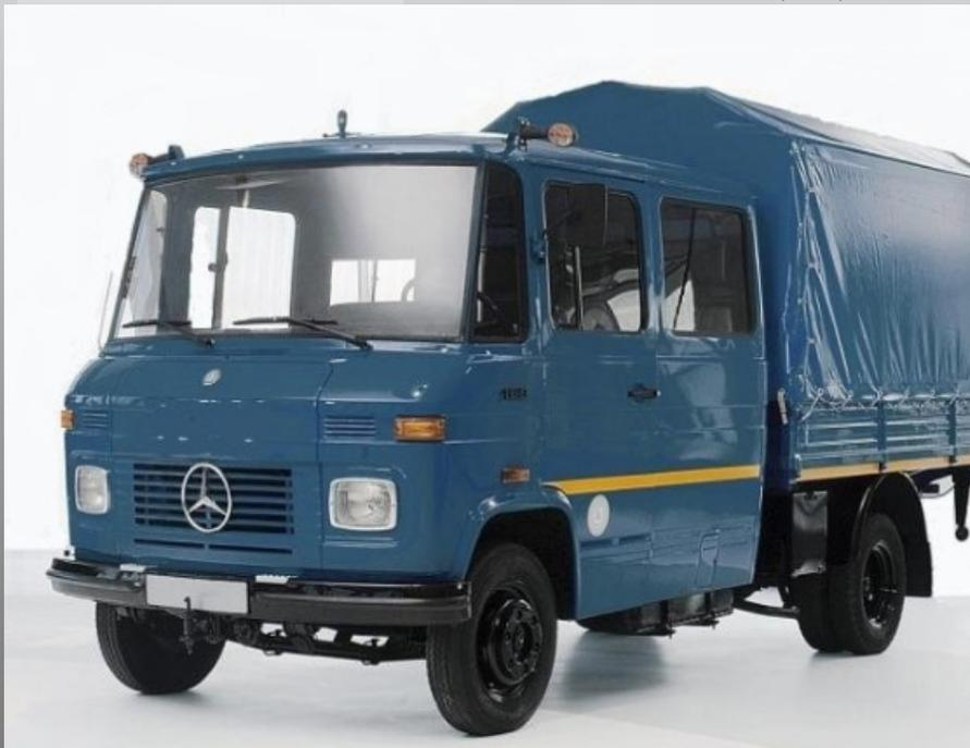
ausgerüstet wurden, erhalten die neuen T2 (rechts) Dieselmotoren mit Direkt Einspritzung. Ottomotoren wurden im T2 (alt) in 3 Varianten und im T2 (neu) nur noch in 1 Variante eingebaut. Die Typen ohne "D" hatten Ottomotoren. Während die alten T2 bis auf eine Ausnahme mit Vorkammer-
