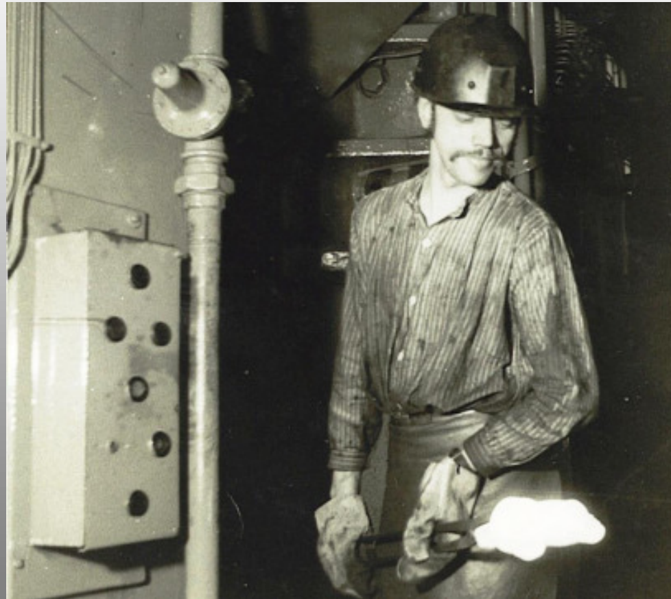
Qualitätskontrolle (Sichtkontrolle) nach dem Abgraten
