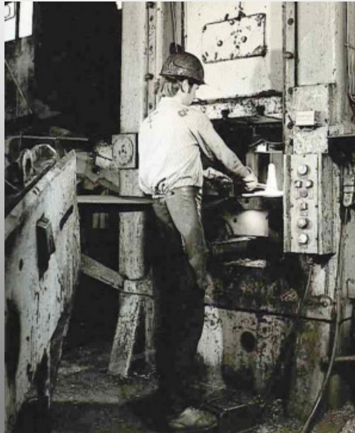
Abgraten von Achsschenkeln an der 500 t Abgratpresse
