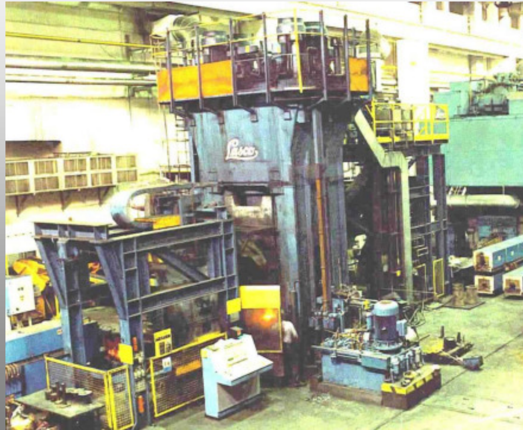
Automatische Schlagfließpresse 1.250 t, Taktzeit 2 bis 3 min
