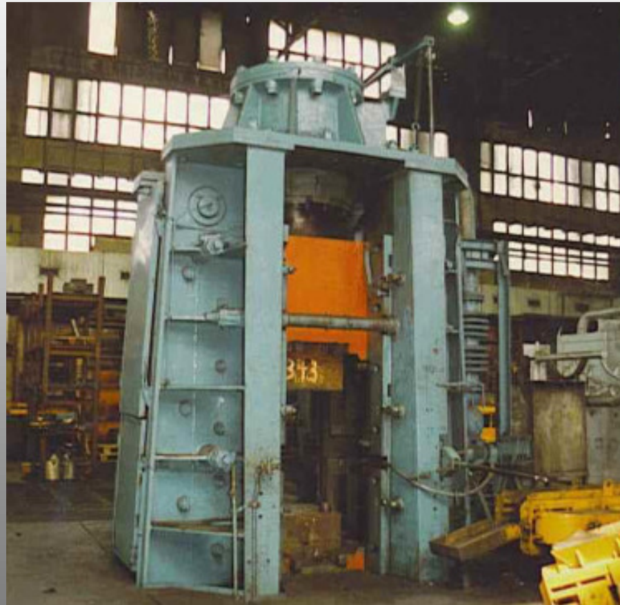
Gegenschlaghammer 10.000 mkg zum Fertigschmieden
