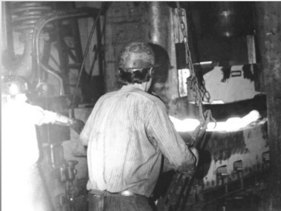
Entnahme der vorgeschmiedeten und gebogenen LKW-Vorderachse
