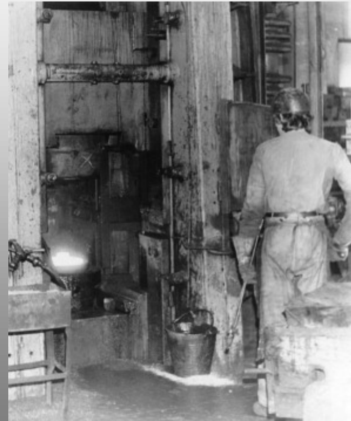
Zahnrad Gesenkschmieden am 10.000 mkg Gegenschlaghammer
