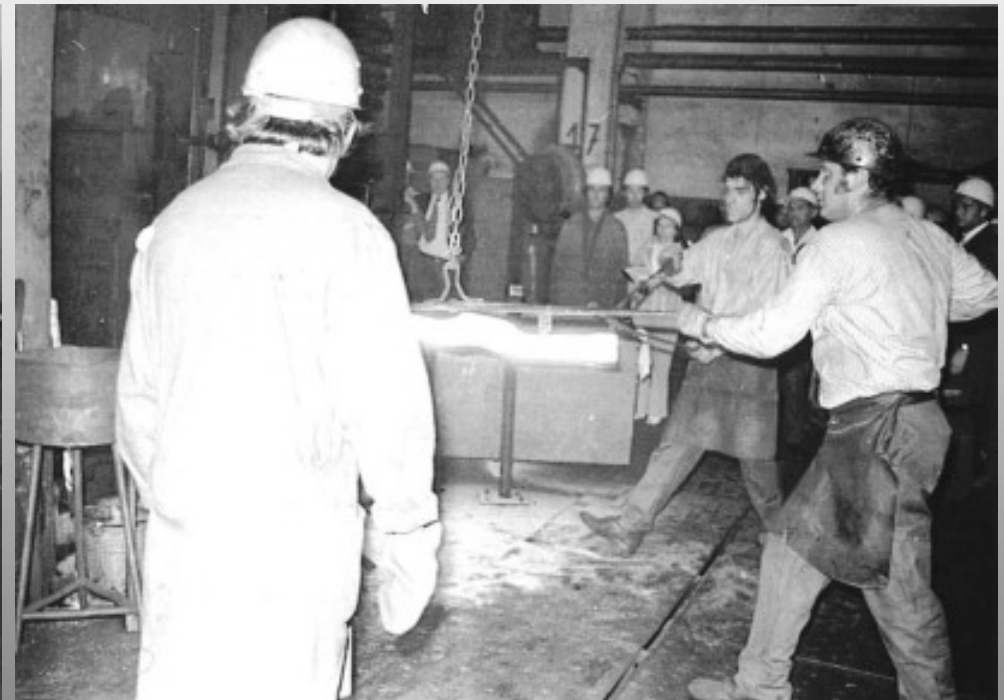
Transport der vorgeschmiedeten LKW-Vorderachse zum 20.000 mkg Gegenschlaghammer
