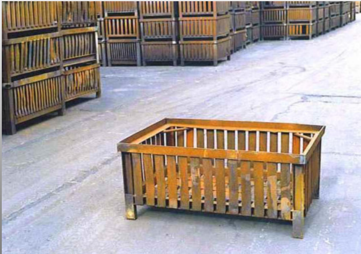
Typische verzugsarme, stapel- und kranbare Schmiedepalette (eine Eigenentwicklung)
