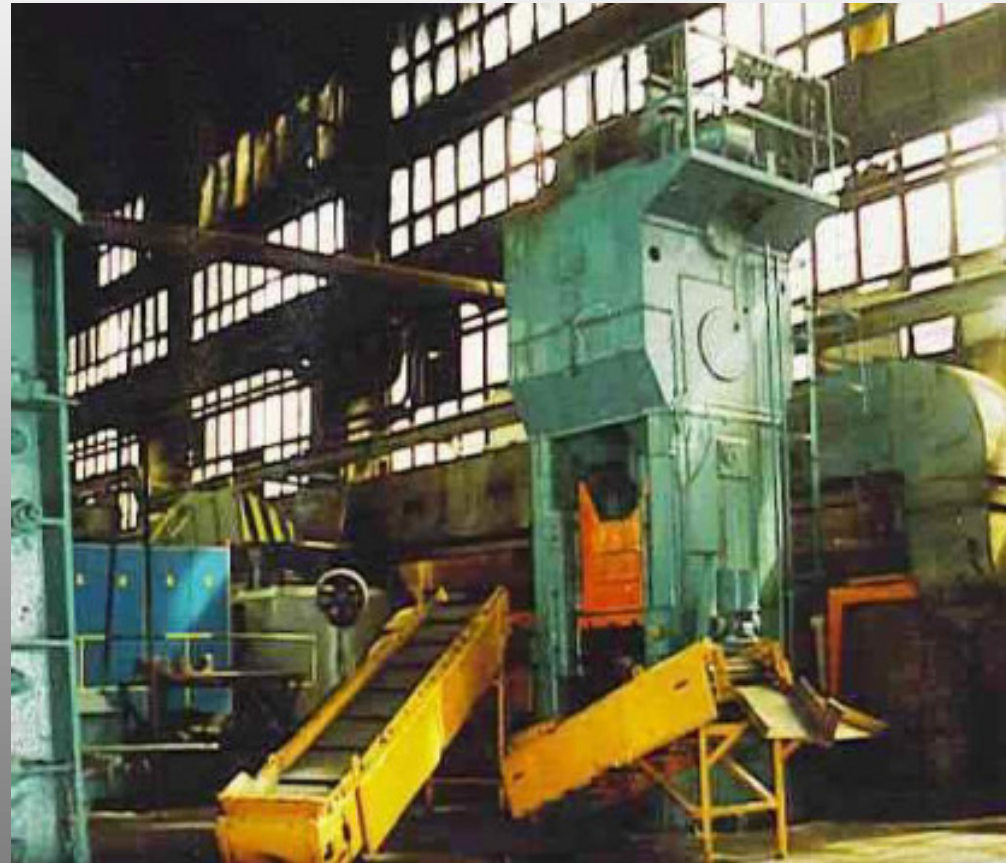
Kurbel-Abgratpresse 500 t mit Förderbändern
