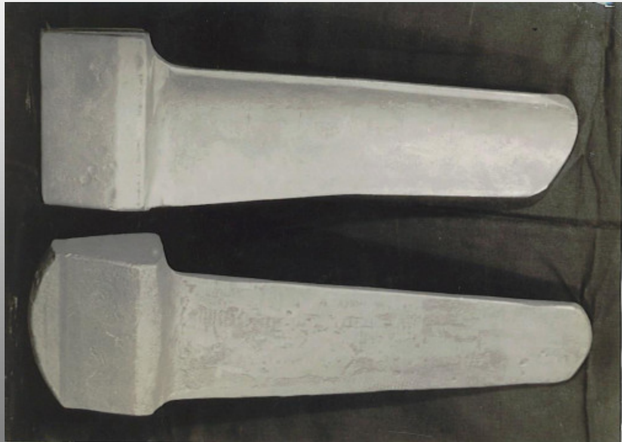
800 mm lange Turbinenschaufeln geschmiedet auf dem Gegenschlaghammer
