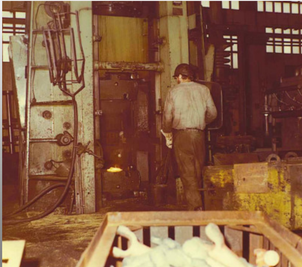
Schmieden von Schaltgabeln am Gegenschlaghammer 10.000 mkg
