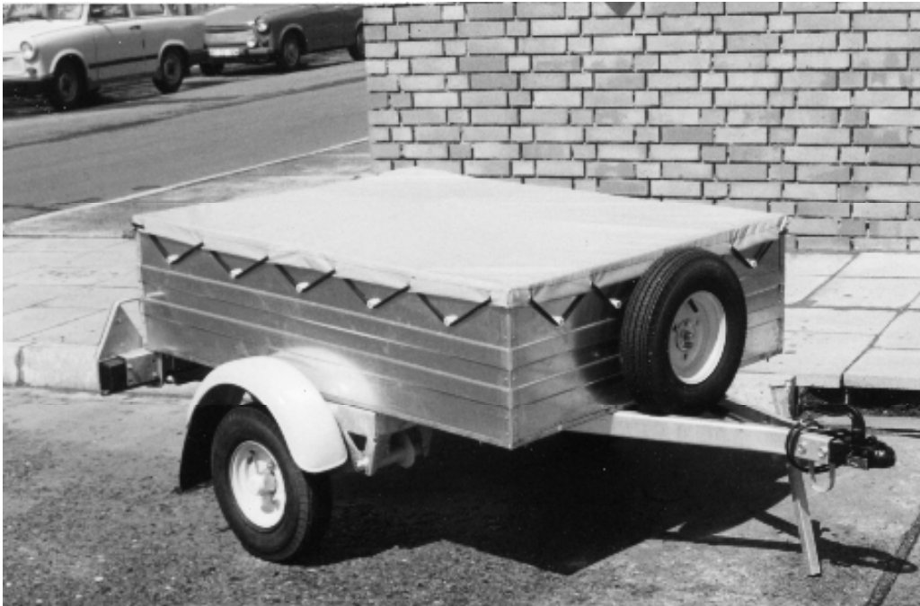
HP 401 mit Blechkasten und Flachplane
