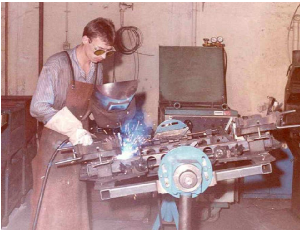
Handschweißarbeitsplatz mit Drehvorrichtung
