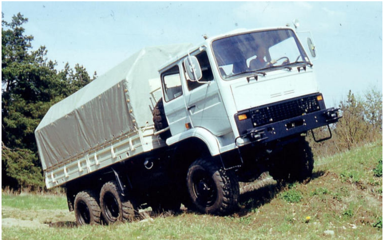
Bild: L 60/1 6×6 MTW FP1 mit Volvo-Fahrerhaus (1980-072-03-1) nach Umrüstung F 301 ab 3/79
