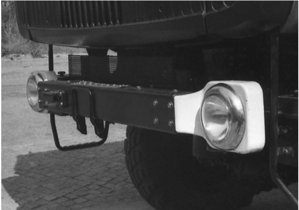
Bild: F103 LAK ab 5/74 mit neuem Fahrerhaus und neuer Stoßstange (97-74-1-1)
