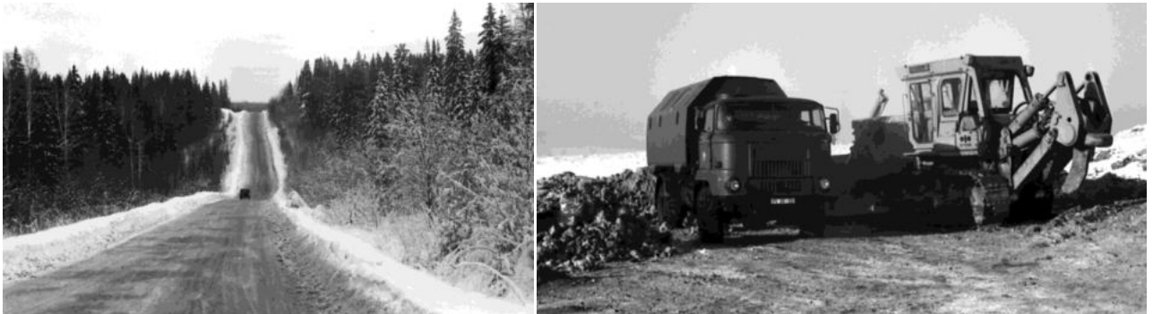
Bild: Straße zur Trasse und L60 4x4 LA/AC ((1988-020-01-1 und 1988-020-05-1) von links Ergebnis: Der L60 ist für den Einsatz in Kälteregeonen bis -30°C geeignet-VB 12/88 (47)
