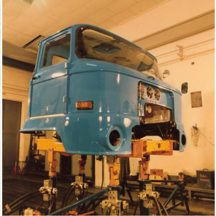
Bild: Lebensdauerprüfungen Planetenachse auf dem GAP(1990-061-01-1) und Fahrerhaus auf der Hydropulsanlage(Fahrerhaus W53) (von links)
