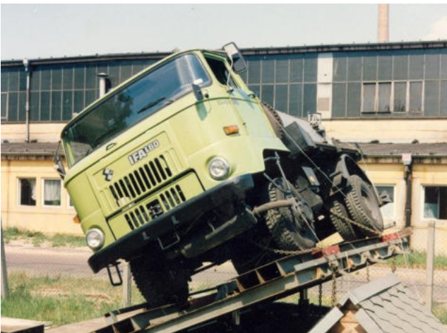
Bild: Prüfung Seitenneigung auf Kippbühne und Kühlkreislauf auf Motorenprüfstand (Scann-Bilder 2-7.3.1.4.8 von links)
