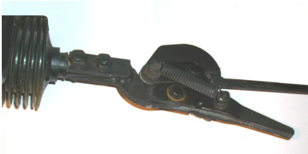
Bild 10: Die Löse-Einrichtung in der Betriebsstellung:
