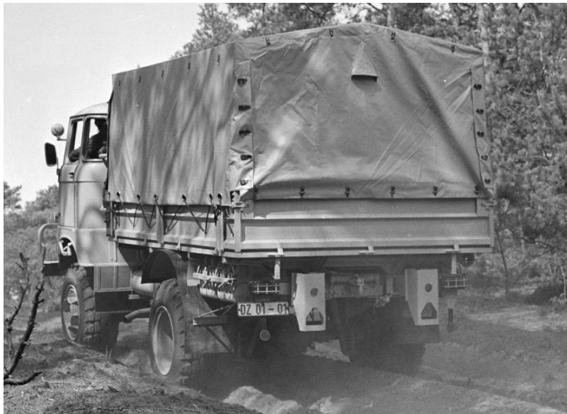
Bild 14: Die in einigen Exportmärkten geforderten Stoßhörner am Heck
