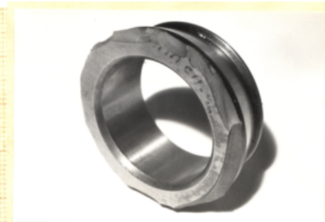
Bild: Die Tragbildverlagerung bis zum max. Drehmoment ist relativ gut (li), während das innere Kegelrollenlager der Antriebskegelradlagerung der axialen Belastung nicht gewachsen ist.
