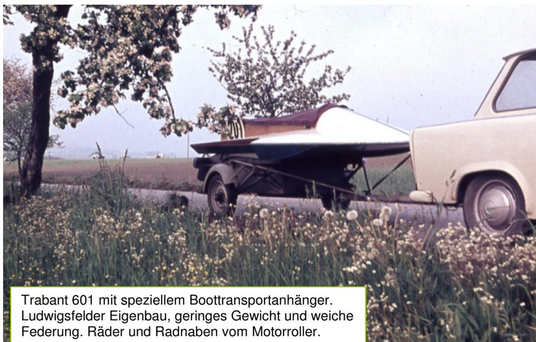
Trabant 601 mit speziellem Boottransportanhänger.
