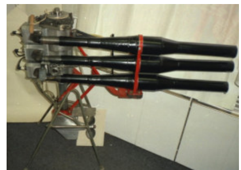
Leistungsangabe beider Motoren: 90 PS (66,2 kW) bei 12000 1/min
